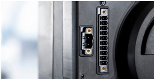
Interfaz con contacto para alarma para controlar el volumen de aire y potencia del calor, por medio de señal de 4-20 [mA] o 0-10 [V] (SYSTEM)
