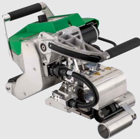
**El GEOSTAR G7 LQS:** Una máquina soldadora de cuña caliente que suelda de forma fiable las membranas geosintéticas en la ingeniería subterránea y de vertederos. Los datos se registran, mientras que los parámetros de soldadura se controlan a través de LQS, GPS y Wi-Fi.
