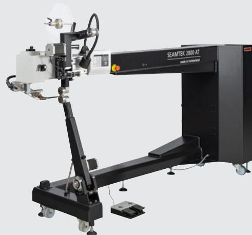
La SEAMTEK 2000 AT ofrece a los usuarios incluso más espacio que el SEAMTEK 900 AT cuando trabajan. Esto permite una soldadura eficiente y segura de grandes productos hechos de textiles técnicos.
