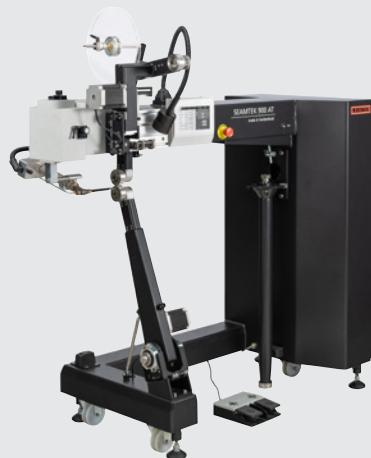
Con la máquina de soldar SEAMTEK 900 AT de bajo mantenimiento, incluso los usuarios inexpertos logran soldar costuras encintadas perfectas, dobladillos, tuberías y soldaduras de cinta. Operación intuitiva a través de la pantalla táctil.
