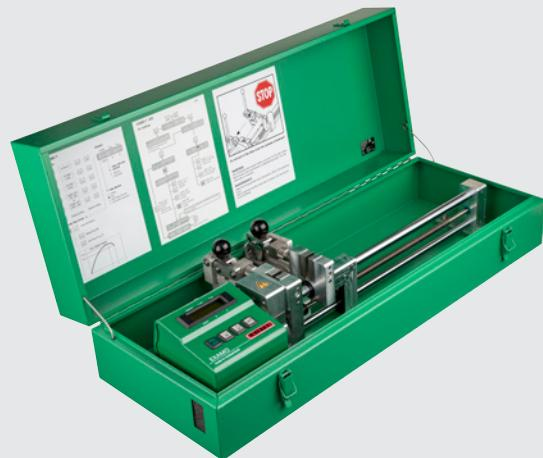
El EXAMO 300F USB es el dispositivo de prueba ideal para verificar la soldadura por costura de membranas contra su adherencia de despegado, resistencia a la tracción y al corte - probado y comprobado en todo el mundo.
