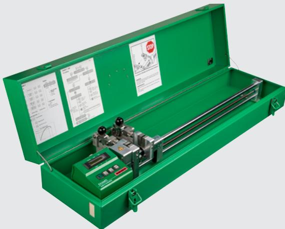
El EXAMO 600F USB es el dispositivo de prueba ideal para comprobar la costura de soldadura de las membranas altamente elásticas en lo que respecta a su adhesión al pelado, la resistencia a la tracción y la resistencia al cizallamiento. Probado y comprobado en todo el mundo.
