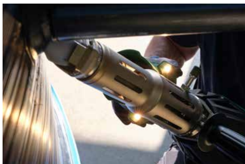
Luz LED para iluminar el área de trabajo
