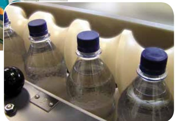
Un sinfín de sincronización mecanizado a partir de Polystone® M-Soft
