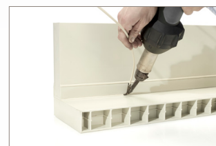
SOLDADURA CON VARILLA
